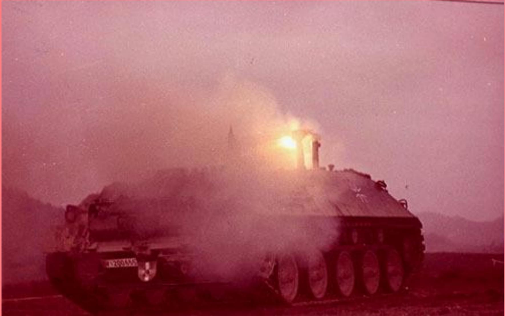
**Abschuss eines Lenkflugkörpers-Panzerabwehrlenkrakete SS11,
