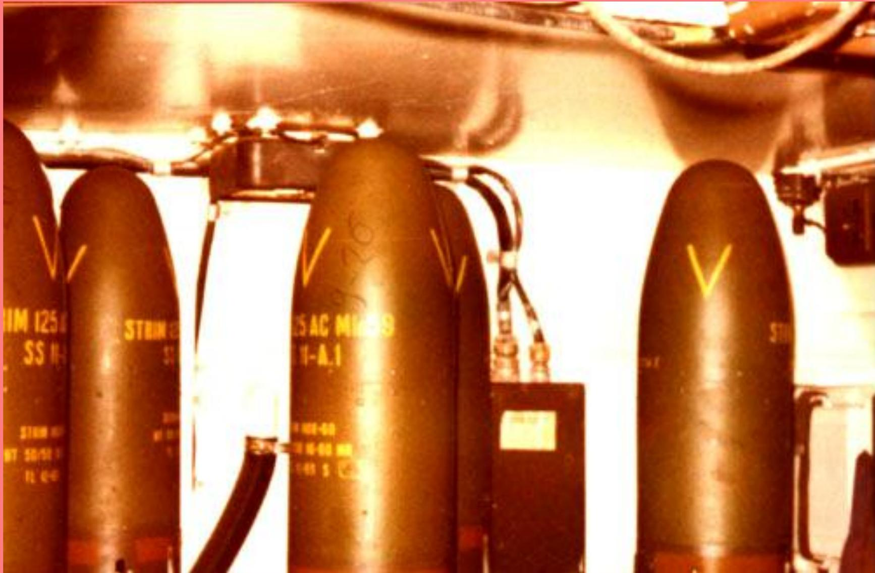
Lenkrakete – Panzerabwehr SS11 im Reservemagazin des Raketenjagdpanzers.
