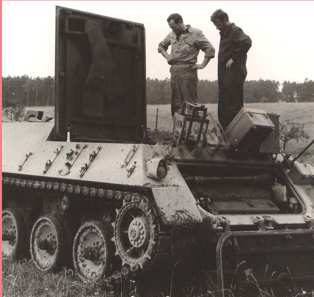
**Ausfall eines Raketenjagdpanzers 1, Überprüfung durch den Schirrmeister der PzJgKp 360, Ofw Nehmiz und eines Zivilen Arbeiters, Ausfallursache, vermutlich Motorschaden.**
